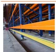
1. **Schleifleitung mit Isolierprofil** \_\_\_\_\_ mit Berührungsschutz ausgelegt nach internationalen Normen
