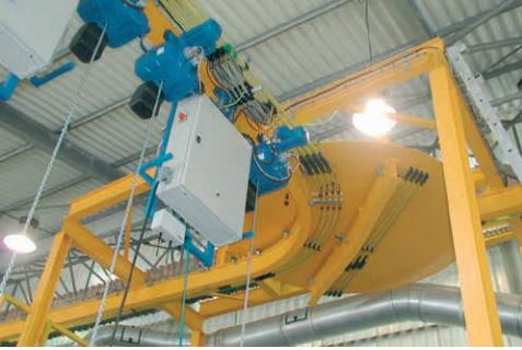
SinglePowerLine 0812 in einer Galvanik-Anlage mit Überfahrtelementen an einer Drehweiche und Doppel-Stromabnehmer
