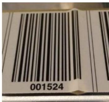
Abb. 36: Positionierband an der Schnittkante trennen
